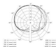
Directivité d'un microphone Sennheiser pour différentes fréquences
